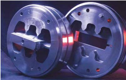
**Nach wenigen Minuten** ist ein Strangpresswerkzeug vollständig bearbeitet. Je nach Bearbeitungszeit können Oberflächenwerte von Ra 0,2 µm und Rz 1µm erzeugt werden.
