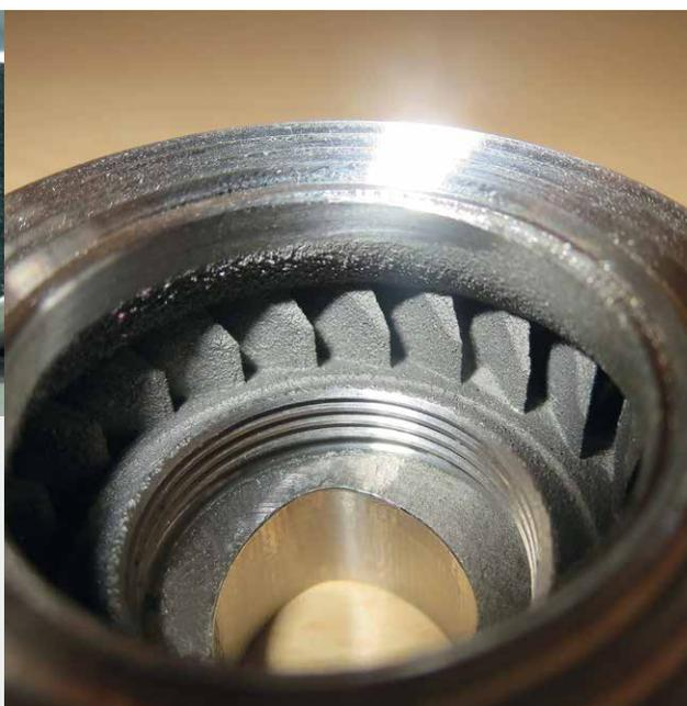
Das benötigte Schleifmedium wird als **Streamer** bezeichnet. Dieser wird individuell auf den zu bearbeitenden Werkstoff, die entsprechende Bauteilgeometrie und die gewünschte Oberflächenqualität eingestellt.
