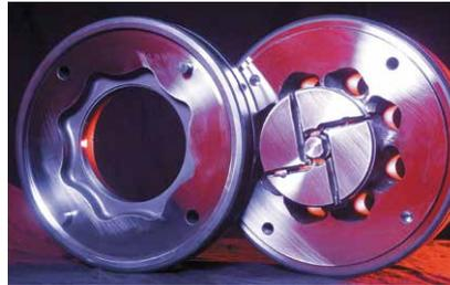
Das MicroStream-Strömungsschleifen entfernt Grau-/Schmelzschichten und kleinere Fissuren und das unter der Gewähr, dass im Profil an allen Stellen **innerhalb kürzester Zeit identische Rauhtiefenwerte** entstehen.
