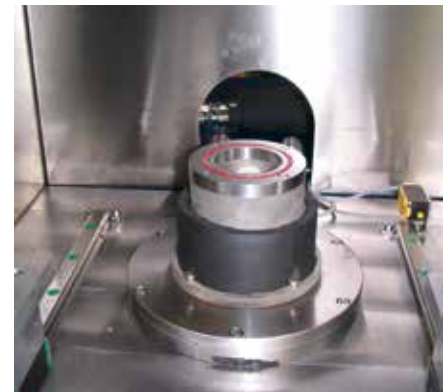
Innerhalb einer kurzen Umbauzeit lässt sich der Durchmesser durch ein oder mehrere Reduzierkits problemlos verkleinern.
